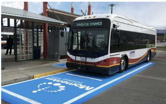
電気バスの超急速非接触充電状況（ウェナチャー）
